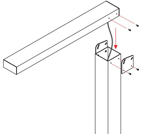
3- Com a energia desligada faça a ligação elétrica diretamente na rede e isole todas emendas com fita auto fusão.
